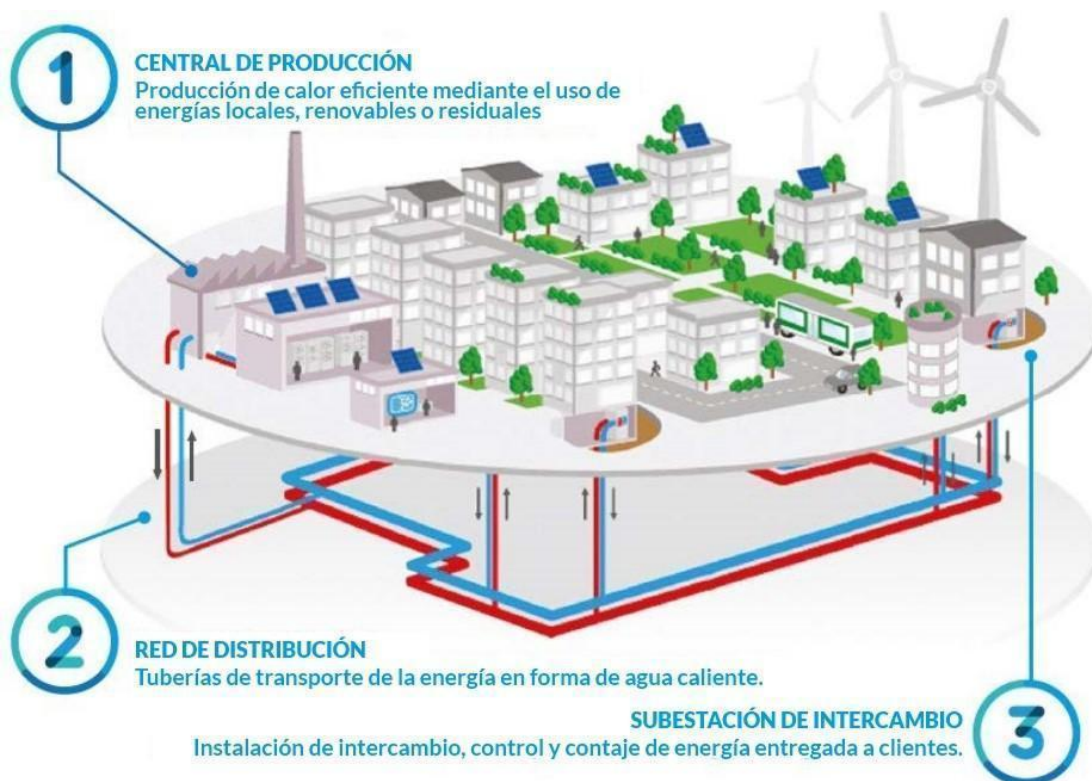
Figura 1: Diagrama conceptual de una red de distrito. 1
