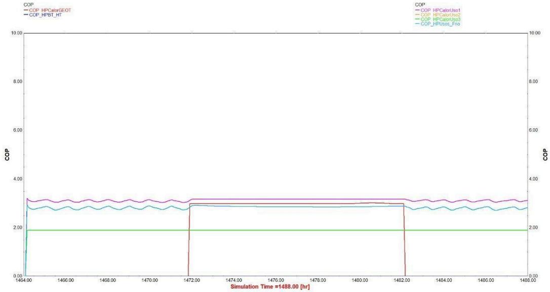
Figura 8. Evolución de los COP de las diferentes bombas de calor que participan en la red de baja temperatura.
